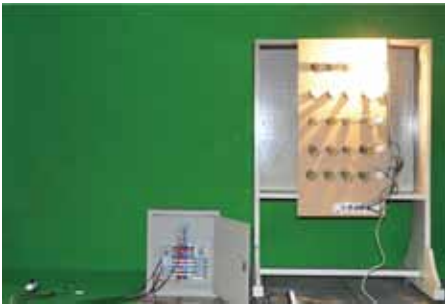
[그림 8] 리튬이온배터리 착화 후(백열전구가 밝아진 상황)
