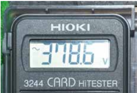
[그림 10] 리튬이온배터리에 인가되는 전압(실험 중 어댑터가 착화되기 전)
