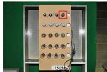
[그림 7] 보조 부하기기의 설치상황 (□표지부분은 실험에 사용된 백열전구)
