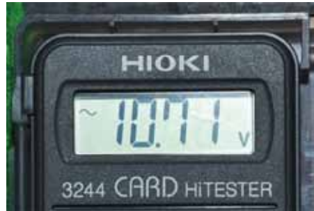
[그림 11] 백열전구에 인가되는 전압(실험 중 어댑터가 착화되기 전)
