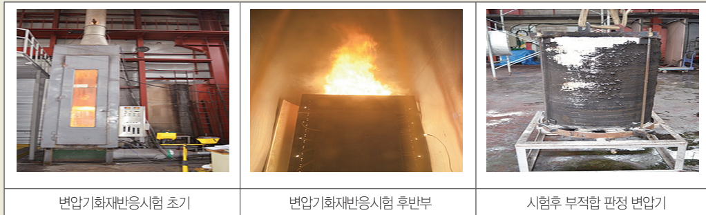
[그림 2] 변압기 화재반응시험
