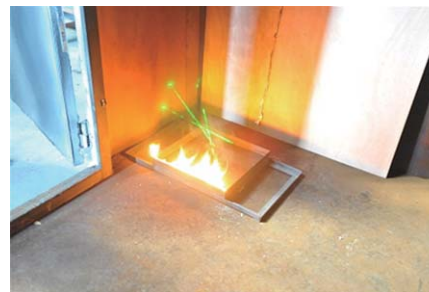
[그림 11] 화염이 존재하였던 팬 위로 각 방향에서 모인 레이저가 교차하고 있는 모습
