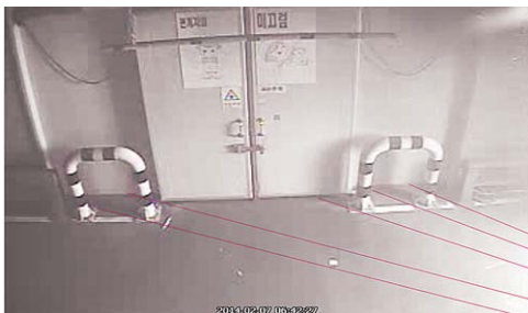
[그림 23] 위 그림자를 토대로 바닥에 인상된 수직 물체의 그림자와 평행하게 연장선을 그린 모습
