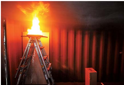
[그림 15] 천정 등 상단부에서 발화하였을 때를 가정하여 170cm 높이에서 연소시켜 실험을 하였다.
