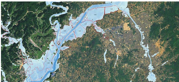
[그림 3] 미호천 인근의 KFPA 하천재해지도 및 침수흔적도
