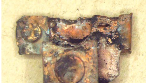
[그림 18] 바이메탈 서모스탯 접점의 연소상황 (수열되고 용융된 상태)
