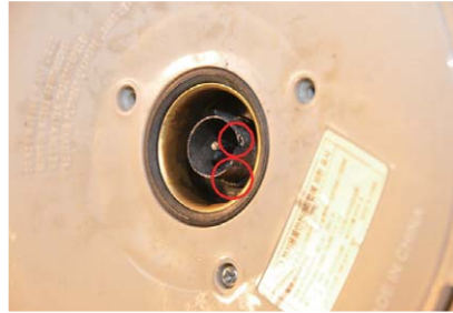
[그림 14] 전기주전자 몸체 하부의 상황 (○표지는 전원단자에 생성된 아크흔)
