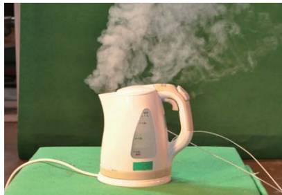
[그림 16] 히터 과열에 의한 전기주전자 열분해
