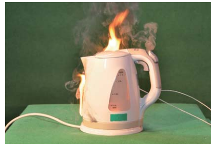
[그림 17] 히터 과열에 의한 전기주전자 착화
