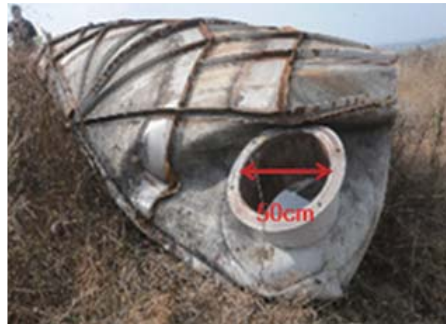
[그림 5] 사고현장으로부터 약 300m 비행 후 인근 들판에 착지한 상부경판, 개구부의 크기는 직경 50cm의 원형임. 1년 이상 개방된 상태로 방치되었다는 관계자들의 진술임.
