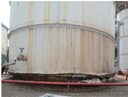
[그림 4] 유류저장탱크 하부 경판의 파열모습
