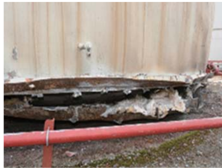
[그림 4] 유류저장탱크 하부 경판의 파열모습
