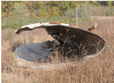
[그림 5] 사고현장으로부터 약 300m 비행 후 인근 들판에 착지한 상부경판, 개구부의 크기는 직경 50cm의 원형임. 1년 이상 개방된 상태로 방치되었다는 관계자들의 진술임.
