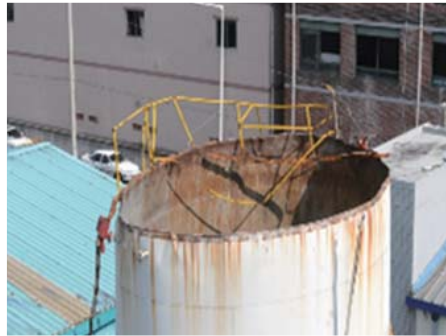
[그림 3] 원통형 유류 저장 탱크의 폭발, 상부경판은 300m 비행 후 인근 들판에 착지
