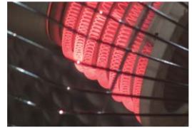
[그림 24] [그림 23]의 ○ 부분, 층간 단락 부분은 기타 부분보 다 밝음.
