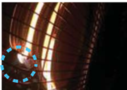
[그림 29] 0.5초 후(○ 표시 부분, 순간적인 스파크 발생)
