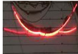
[그림 19] 27초 후 (○ 표시 부분, 국부적으로 니크롬선의 밝기가 증가함)
