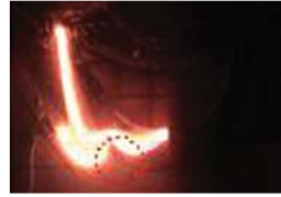
[그림 15] 12초 후(급속히 늘어 지면서○표지부분에서 스파크 발생)
