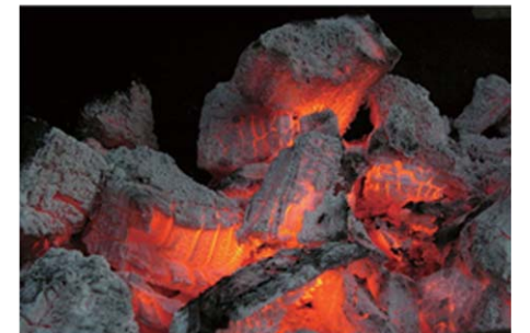
[그림 1] 목탄의 표면연소 : 화염이 발생하지 않으며 산소와 접촉하는 표면에서 작열하고 있다. 목탄은 이미 열분해가 완료된 물질이므로 연소 시에도 가연성 기체가 발생하지 않으며 고온의 환경에서도 화염이 발생하지 않는다.
