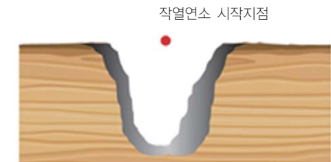
[그림 5] 작열연소에 의한 심부연소, 외기에 의한 냉각에 의해 표면보다는 심부를 향한 연소속도가 더욱 빠르다.
