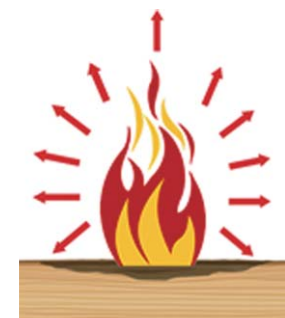
[그림 4] 화염에 의해 가연물 표면이 연소하기 좋은 조건이 되므로 화염연소에서는 표면을 따르는 연소속도가 더욱 빠르다.
