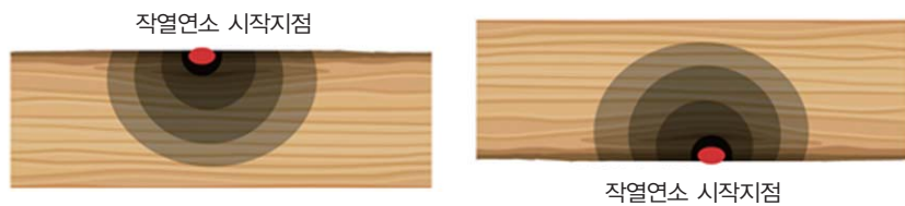
[그림 3] 작열연소는 대류의 영향이 작으므로 가연물 설치 각도 및 점화위치에 따른 연소속도의 차이가 크지 않다.
