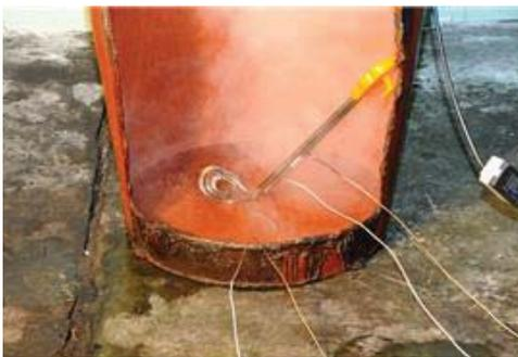
[그림 25] 3kW 시즈히터(안전장치 미설치)에 의한 가연성용기 착화 실험
