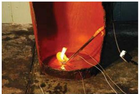
[그림 26] 3kW 시즈히터(안전장치 미설치)에 의한 가연성용기 착화 실험
