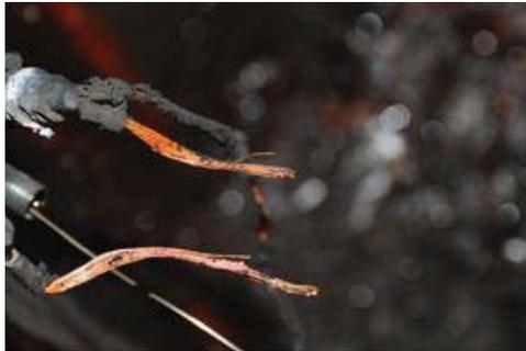
[그림 19] 3kW 시즈히터(안전장치 설치)의 전원코드에 발생된 단락흔
