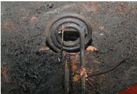
[그림 27] 3kW 시즈히터(안전장치 설치)의 연소흔
