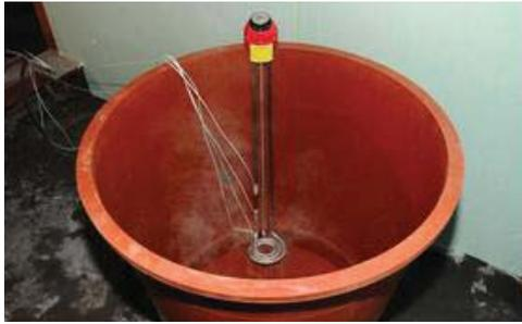
[그림 21] 5kW 시즈히터(안전장치 설치)에 의한 가연성용기 착화 실험
