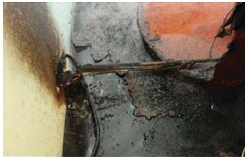
[그림 23] 5kW 시즈히터(안전장치 설치)의 연소흔
