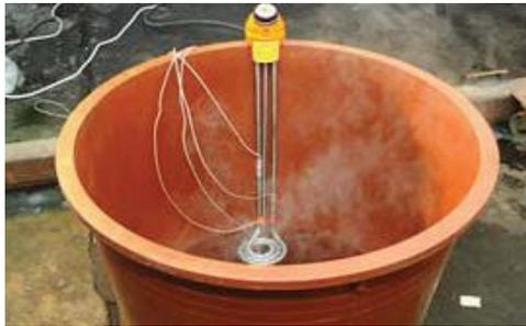
[그림 17] 3kW 시즈히터(안전장치 설치)에 의한 가연성용기 착화 실험
