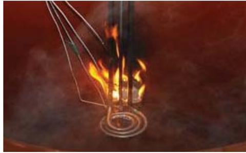
[그림 22] 5kW 시즈히터(안전장치 설치)에 의한 가연성용기 착화 실험
