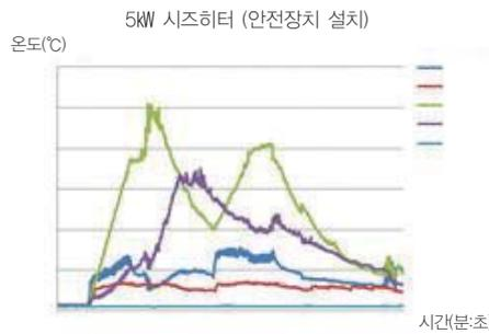
[그림 24] 5kW 시즈히터(안전장치 설치) 시간-온도 그래프
