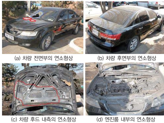
[그림 4] 화재가 발생한 차량의 연소형상
