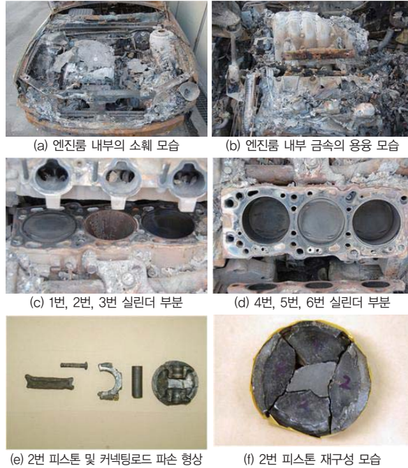
[그림 3] 엔진룸 및 피스톤 파손 형상
