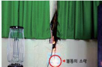
[그림 6] 콘센트의 용융물(불뚱) 소리(콘센트 착화 후 1분 39초 경과)
