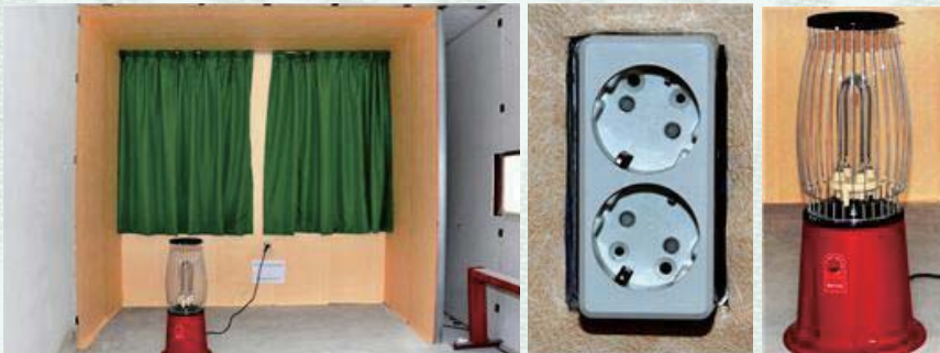
[그림 3] 실험장치(좌측부터 세트장, 접지노출2구 콘센트, 전기스토브)
