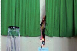
[그림 5] 종이벽지를 통한 연소확대 및 커튼으로 인한 연소확대 방지
