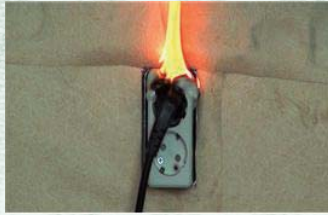
[그림 4] 콘센트 외함의 착화(플러그 체결 후 9분 43초 경과)
