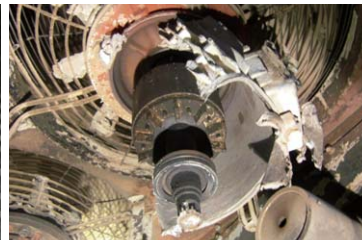
[사진 11] 배기모터 파손
