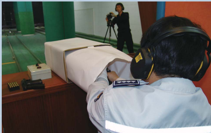
[사진 2] 사대를 밀폐한 상태에서 권총 격발 모습
