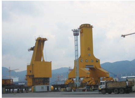
[사진1] 태풍으로 인하여 붓대 부분이 분리된 크레인 모습
