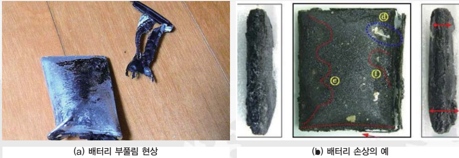
[그림 7] 배터리 결함에 의한 화재에서 배터리 손상형태
