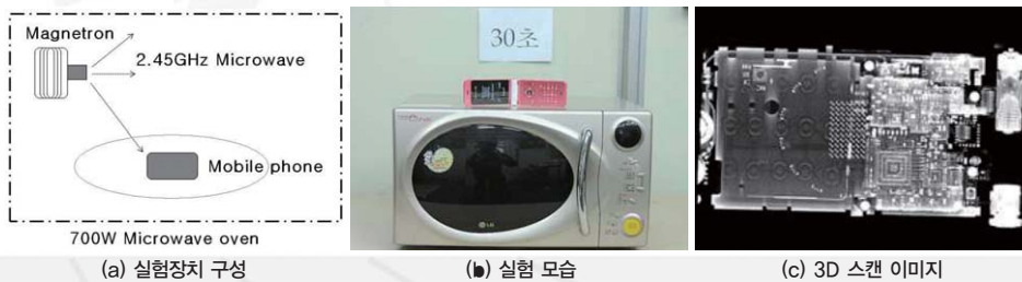
[그림 2] 실험장치의 개략도 및 실험 모습
