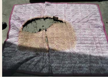
[사진 6] 전기매트 하부의 연소상황 (중앙부분만 국소적으로 연소된 상태이며, 기타 부분에는 열선에 의한 과열현상이 보이지 않음)
