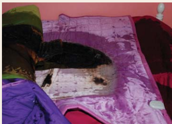
[사진 1] 화재당시 침대 상부 전기매트 등의 연소 상황(3월 20일) (하부에서부터 순서 : 침대커버, 전기매트, 라텍스 매트, 거위털 이불)
