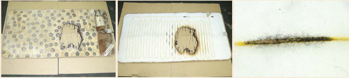
(a) 소화된 전기장판 (b) 전기장판 열선의 구성 (c) 탄화된 열선
