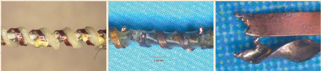
(a) 열선피복 용융형상 (b) 열선과 감열선의 단락형상 (c) 단락형상의 확대 모습
