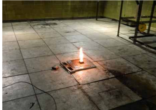
<그림 4> 영상화재감지기 화재실험 - N Heptane pan
