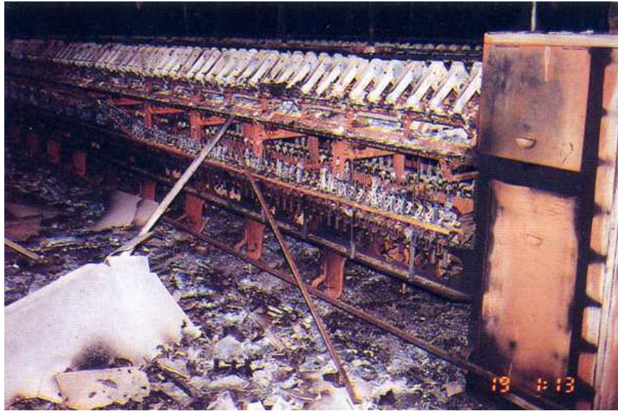
[사진 2] 최초로 연기냄새가 감지된 정방부의 소실 상태
