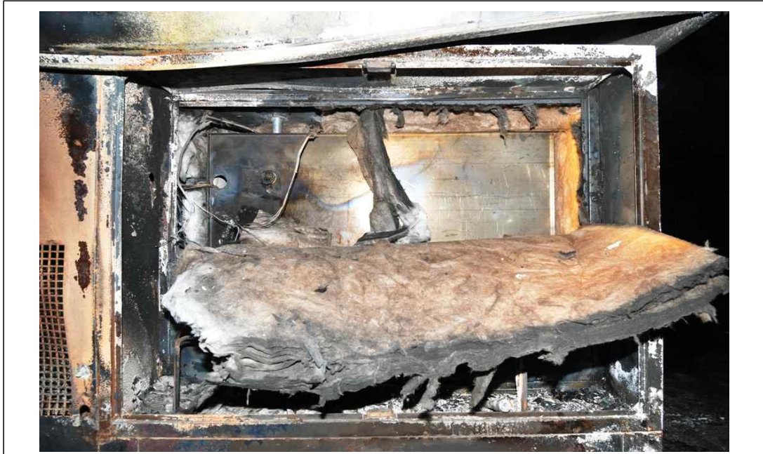
[사진 7] 사진6의 □표지부분, 시험장치의 단열재(글라스 울)
