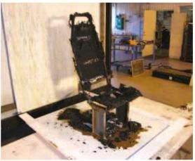
버스 좌석에 대한 화재 시험 결과는 또 다른 시험 방법을 비교하거나 화재진행 시뮬레이션의 데이터 input값을 제공하기 위해 사용되어 진다.
