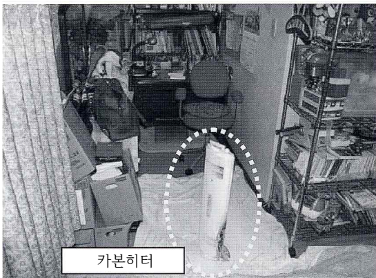
<사진1 : 발화실 내부 상태>
