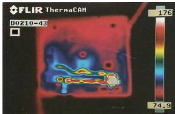
<사진2. 무한제어장치 내부의 온도발생장치의 온도기록도>
