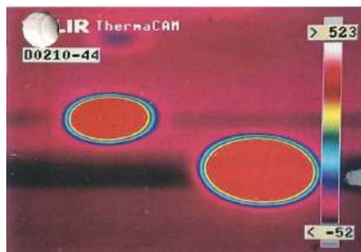
<사진5- 유리 쿡탑의 버너 2개의 온도기록도로 다른 위치의 버너에는 열전달이 거의 없음을 보여준다.>
