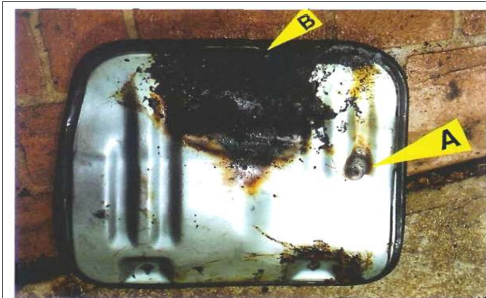
[ 축전지 저장소의 커버, A는 원모양의 불에 탄 자국, B는 하부 말단 연결부의 열에 의한 손상 ]
