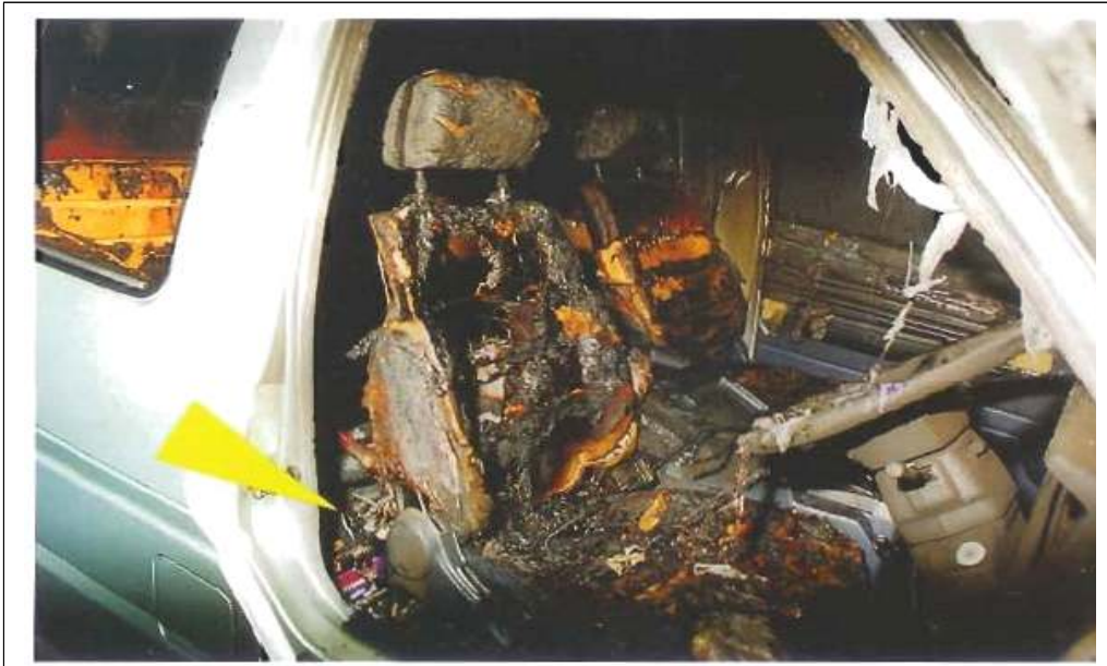
[ 화재의 피해상황을 보여주는 차량 내부(화살표는 축전지 저장소) ]
