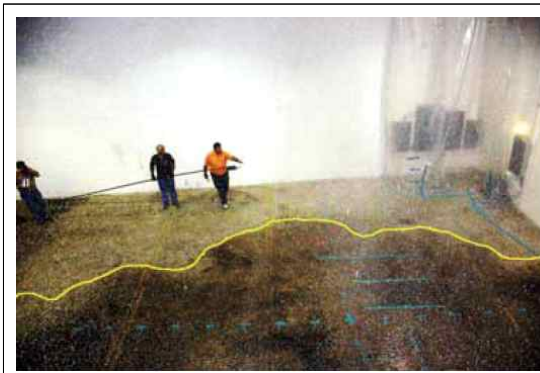
그림16: 바닥에 노란색 라인은 # 7 스프링클러 헤드 물분무 패턴을 나타냄.
