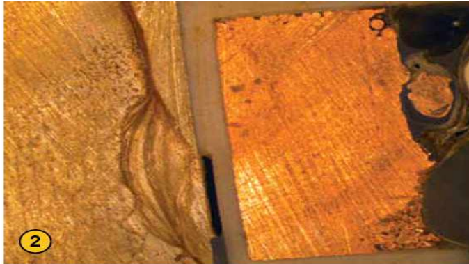
<사진 2>는 절개 후 세정 전 상태의 1차 권선 (그림의 오른쪽)을 현미경으로 촬영한 모습이다. 미세한 전도체가 절단바퀴의 작동으로 인해 어느 정도 오염도 되어있다. 사진의 왼쪽에 있는 물질은 철심/라미네이트 스택 (laminare stack)의 일부이다.
