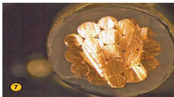
<사진 7>은 절개된 후 세정되지 않은 절연체의 횡단면이다.
