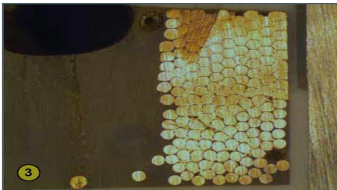
<사진 3>은 180 그릿으로 세정한 2차 권선이다. 이 사진에서 2차 권선에 있는 대부분의 컨덕터 들을 쉽게 셀 수 있다.
