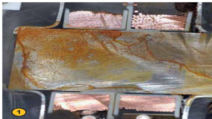
<사진 1> 은 변압기를 함침한 후, 반으로 절개한 변압기의 횡단면이다. 왼쪽이 1차 권선들이며 오른쪽이 2차 권선들이다.
