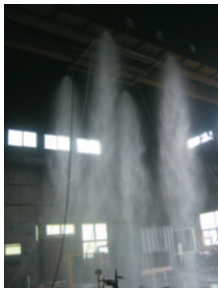
그림. 1 국소방출방식 배관 그리드 및 분무장면
