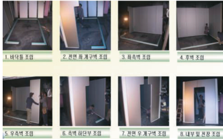
【그림 2】 ISO 13784-1 RRT 시험체의 제작 과정
